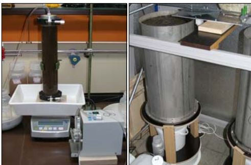
Von unten durchströmte Säule (links), von oben beregnete Säule mit ungestörter Bodenprobe (rechts), Fotos: LFU
