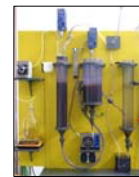
Laborkläranlage, Foto: LfU
