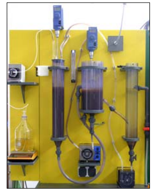
Laborkläranlage, Foto: LFU
